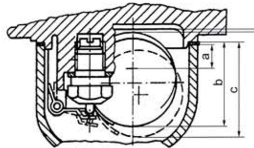
Mindestabstand 0,5 mm bei eingefedertem Nadelventil
